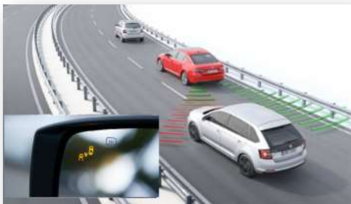
شکل ۱۰: نحوه عملکرد سیستم پایش نقاط کور خودرو
