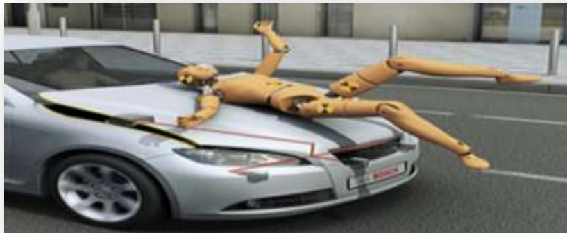
شکل ۱۳: سیستم حفاظت از عابر پیاده به هنگام تصادف
